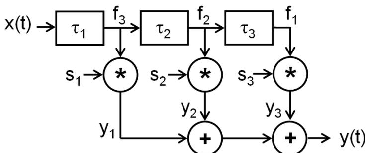
**Bild 3: Physikalisches FIR-Filter mit drei Koeffizienten als Interferenznetzwerk**
