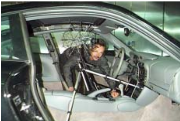
Bilder: Kugelarray im Innenraum eines PKW; Knackende Frontscheibe auf dem Rüttelprüfstand
