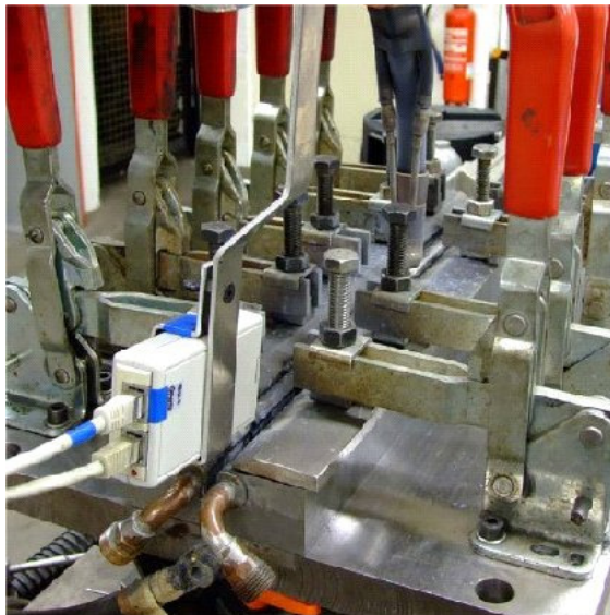
Bild: Blick auf den Versuchsstand. Der Prototyp des Spektralreglers (im Bild links vorn) schweißt seit November 2007 beim Projektpartner TU Berlin, IWF. Im Hintergrund ist der Brennerkopf zu erkennen. Foto: Frank Hofmann, TU Berlin
