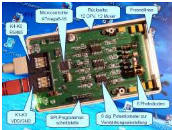
6-Kanal DC- Chopper- Amplifier (Champ6) als Basis neuer Spektralregler im Bereich von 0,3 bis 3 \mu\text{m}
