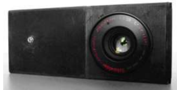
Prototyp des Spektrometers: Der Kollimator steckt im linken Gehäuseteil, rechts ist das Objektiv zu erkennen
