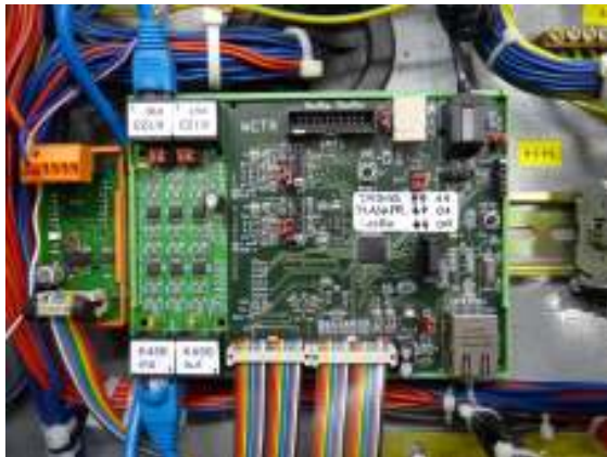
8-Kanal Schweißregler WCTR mit Cortex-M3 (32 Bit) in Schweißmaschine Cloos-Quinto GLC403
