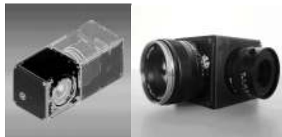
Links: 3D-Modell des Spektrometers, Rechts: Realisiertes Kamerahaus mit Kollimator (li) und Frontobjektiv (re)
