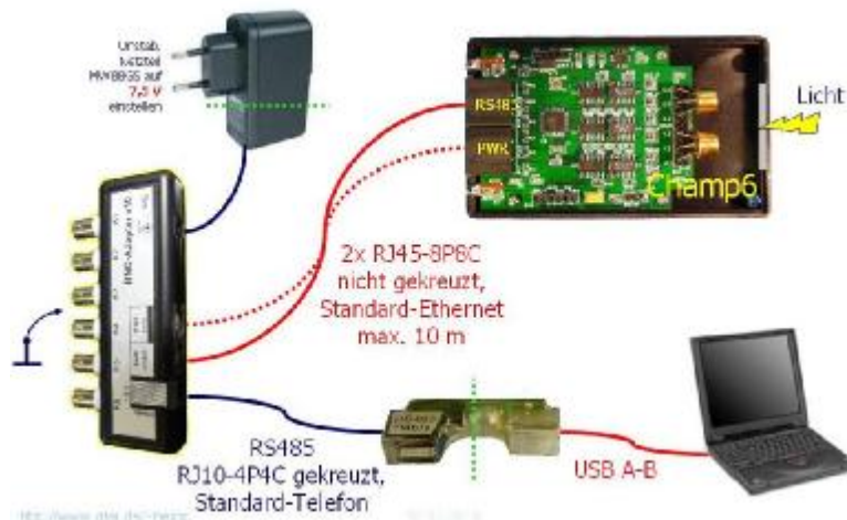
Abb.1: Ein Experimentierkit mit Champ6v20 wurde für den Aufbau von Spektrallabors in der Schweißgeräteindustrie entwickelt und aufgebaut. Der PC-Anschluß über USB dient der Einstellbarkeit der Verstärkung der Kanäle.
