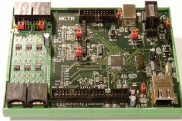
Abb.2: 32-Bit Spektralregler WCTR mit ARM-Cortex-M3 (STM32F103RET6).
