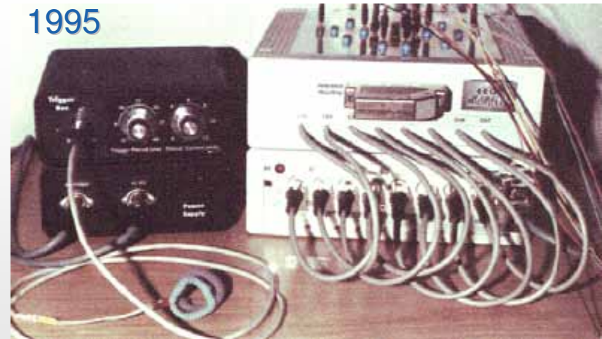
EEG-Vorverstärker – Diplomarbeit M. Fritsch, 1994
