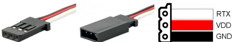
Abb.6: Für Experimente können Servostecker als SWART-Stecker genutzt werden (hier Bauart Futaba). vlnr: Stecker, Kupplung (Buchse), Layout (Sicht auf Buchse)
