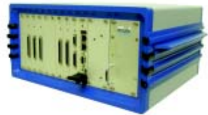
Bild 1: Neuer Datenrekorder der Akustischen Kamera
