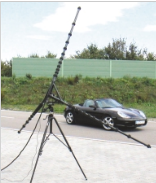
Star 36-Array an der Messstrecke
