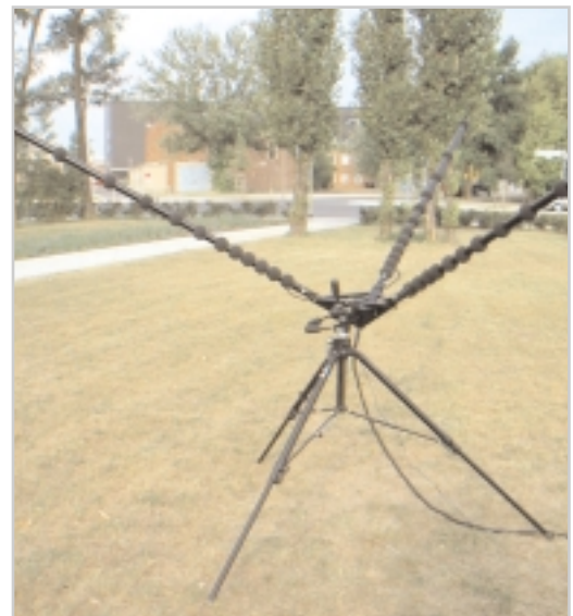
Star 36-Array bei der Messung von Überfliegergeräuschen
