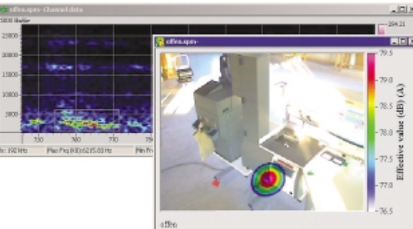
Markiertes Geräusch im Spektrogramm wird im Akustischen Bild zugeordnet
