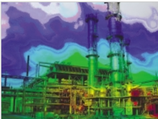
Akustisches Bild einer Industrieanlage, aufgenommen aus 300 m Entfernung
