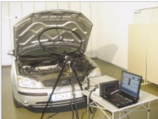
Messung von Motorgeräuschen
