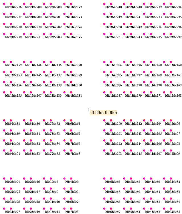
Fig. 4: Geometrische Anordnung der Mikrofonkanäle (von vorn)
