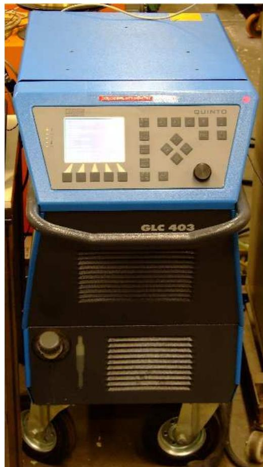
**Abb. 11: Erste, mit Spektralregler ausgerüstete Schweißmaschine**
