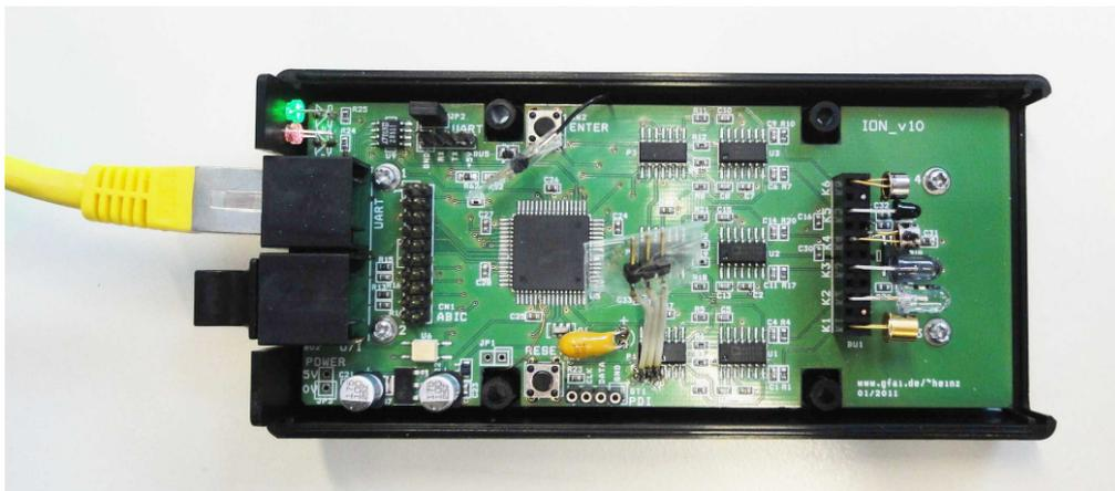
**Abb. 4: Im Projekt entstandener 8-Kanal Spektralregler Ion – erster praktikabler, soft-gesteuerter Spektralregler für Pulsschweißmaschinen**
