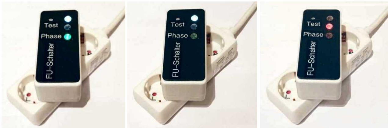
**Abb.2 Links: Aktivierter Zustand - die LEDs weiß und grün müssen leuchten. Mitte: Der Stecker steckt verkehrt herum in der Steckdose, die LED3 "Phase" bleibt dunkel. Rechts: Der FU-Schalter speist einen Fehlerstrom ein, nur die rote LED2 leuchtet. Oberhalb des Aufdrucks "Test" ist die versenkte Test-Taste PB1 zu erkennen, die mit einem Bleistift oder Kugelschreiber auslösbar ist.**
