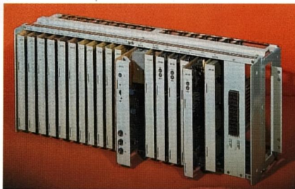
Bild 32 Leiterplattenwanne Aufnahmerahmen für SpUs
