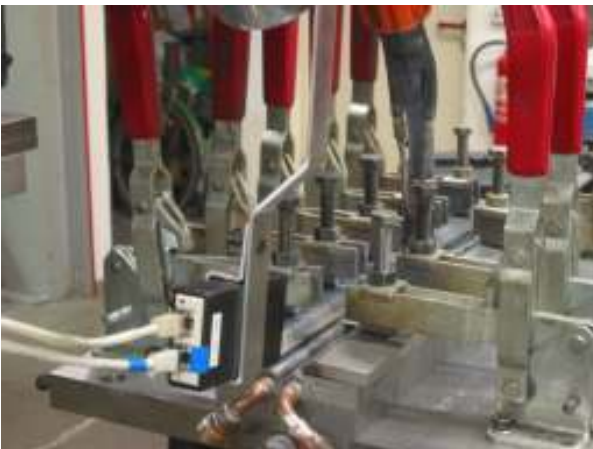
Abb. 10 Versuchsaufbau an der TU Berlin. Hinten der Brennerkopf, vorn der Spektralregler [3]
