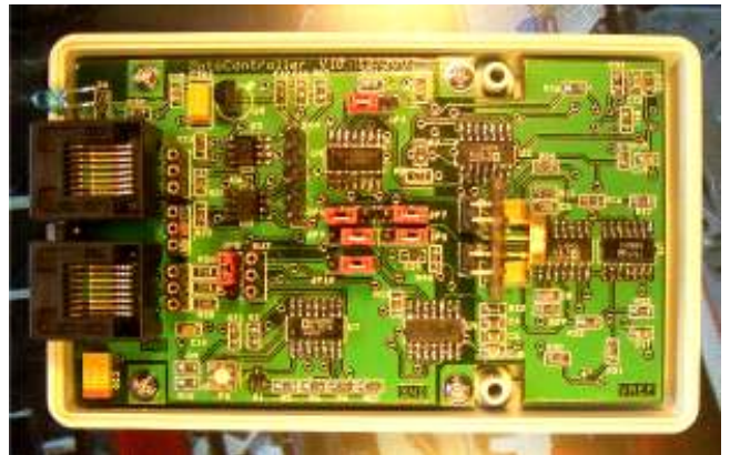
Abb.12 Blick in das geöffnete Gehäuse [4] des zweiten Prototyps. Ein isolierendes Gehäuse mit innenliegender Schirmung sowie eine vierlagige Leiterplatte schützen vor kapazitiver und induktiver Einkopplung der Schweißmaschine
